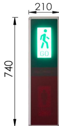
Abb. 3: Maße GEHÄUSE in mm
